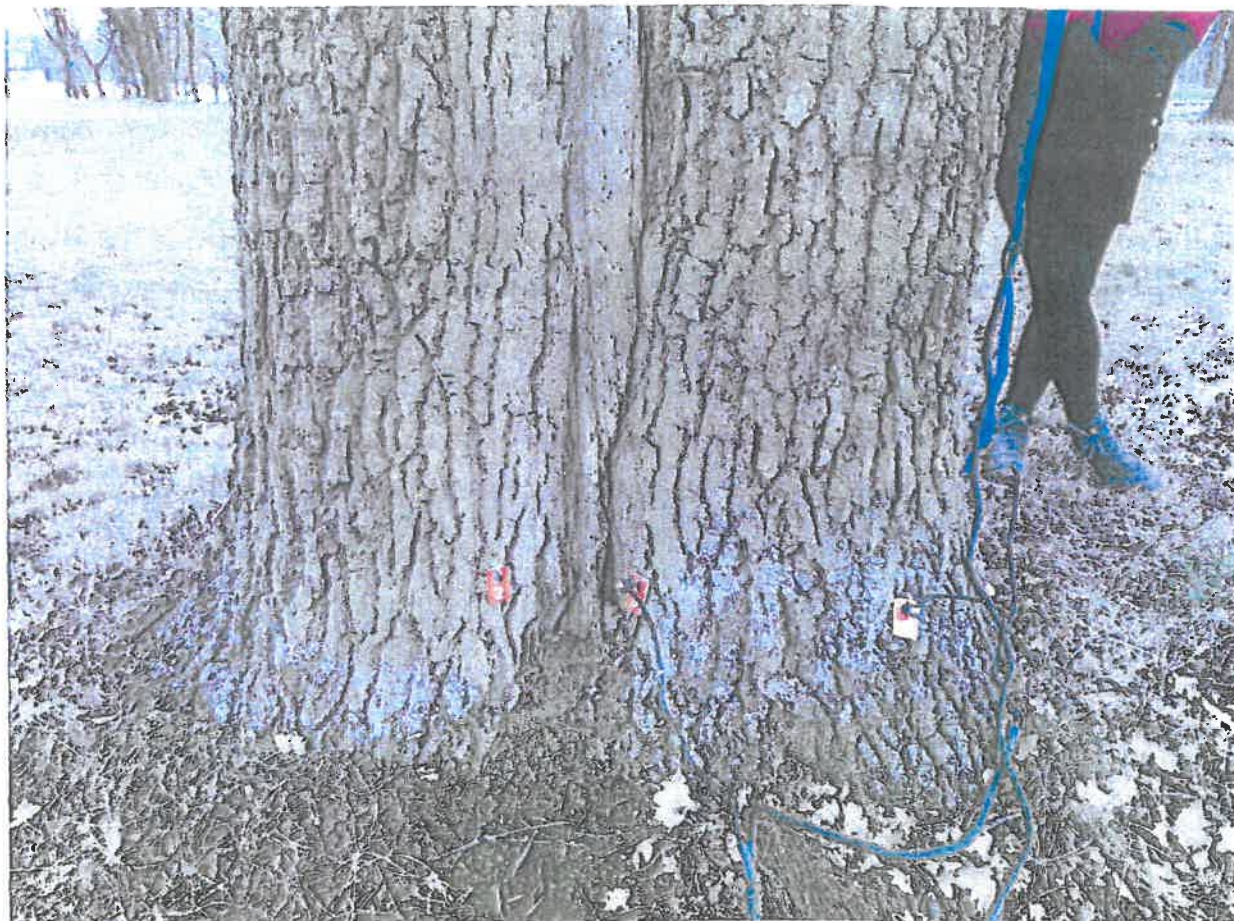
Fot. 5. Widok poglądowy na szyję korzeniową drzewa nr 5 – dąb szypułkowy z widocznymi punktami pomiarowymi.
